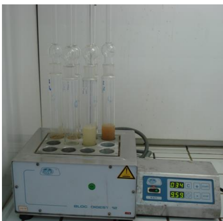
Figura 17 – Bloco digestor com os respectivos tubos de Kjeldahl.
